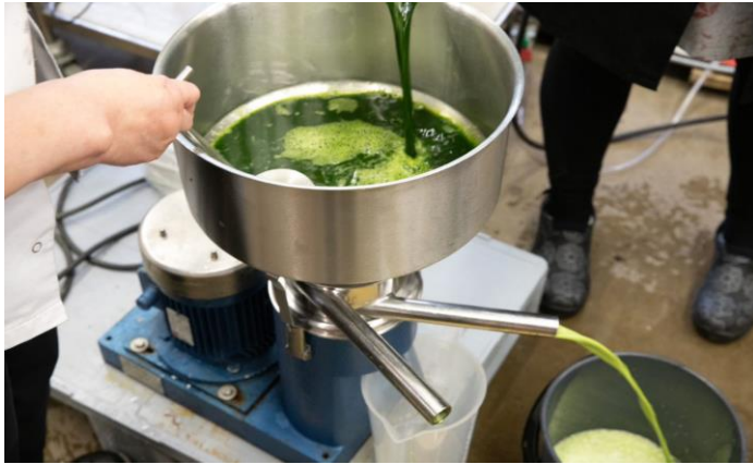
Kuva 2.2. Kurkun varsi-lehti-puristenesteen separointi, Frau CN3 -laboratorioseparaattori.
