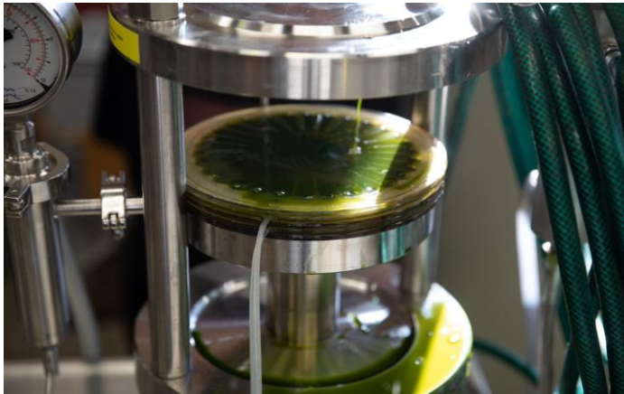
Kuva 2.3. Mikro-suodatus tehtiin LabStak M20 -suodatuslaitteistolla.
